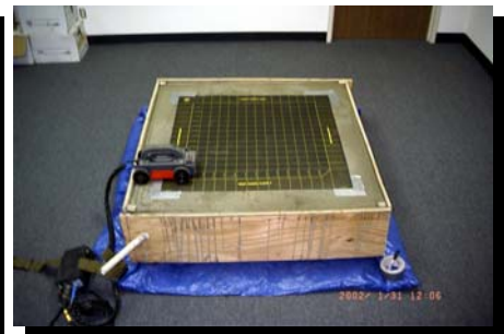
Detect PVC Conduit
